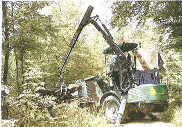
Riesige Kräfte sind notwendig, um das Baumholz in kleine Holzschnitzel zu verkleinern.
